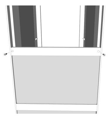
• Нужно положить стеклянную полку на полкодержатели, так же вставив ее в опорно-разделительную планку.
